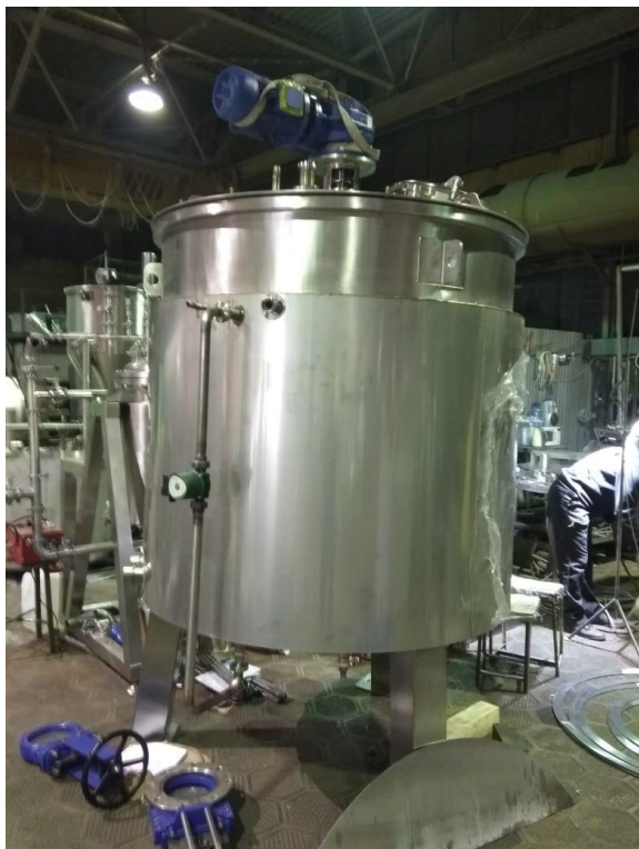
Рис.3.21. Вакуумный реактор. Мешалка вакуумного ректора
