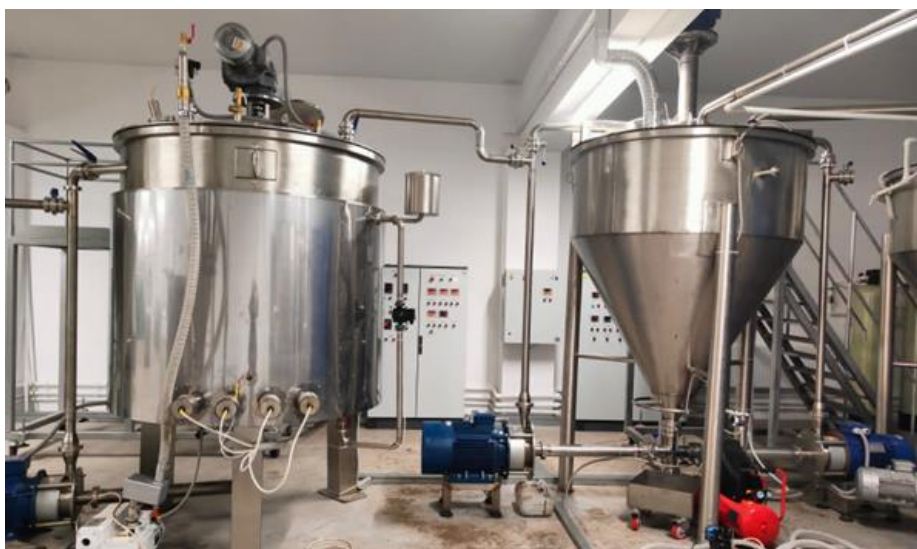
Рис. 3.13. С лева на право: вакуумный реактор, диссольтвер
