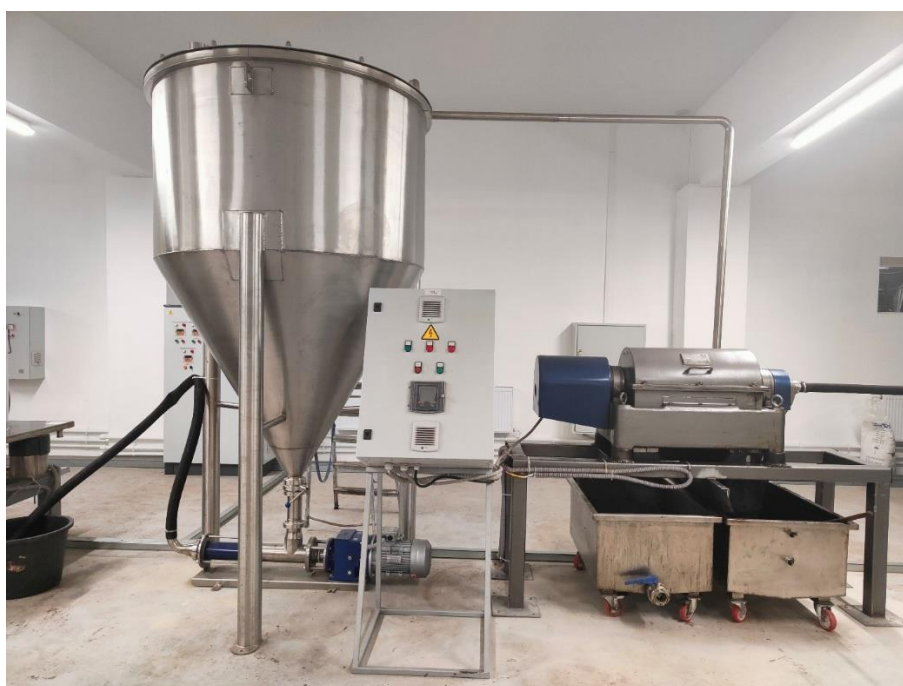
Рис.3.14. Стабилизационная колонная и горизонтальная центрифуга, пульт управления
