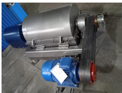
Рис.3.27. Горизонтальная центрифуга. Активатор воды
