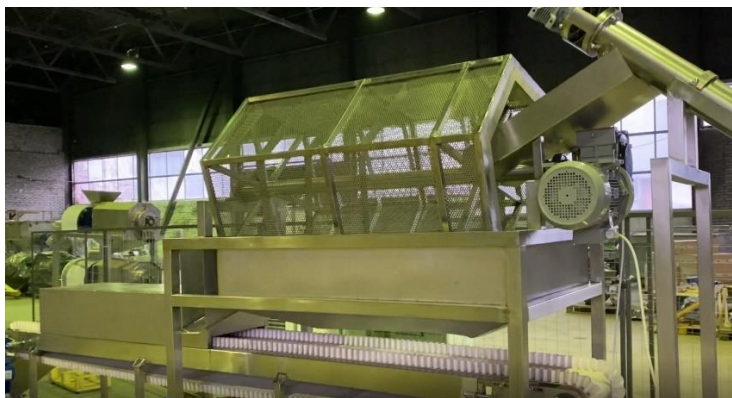
Рис.3.7. Приемная воронка бункер, сито шестигранное для предварительной очистки торфа, ленточный транспортер инспекционного тип РТЛИ с лампами УФ -излучения
