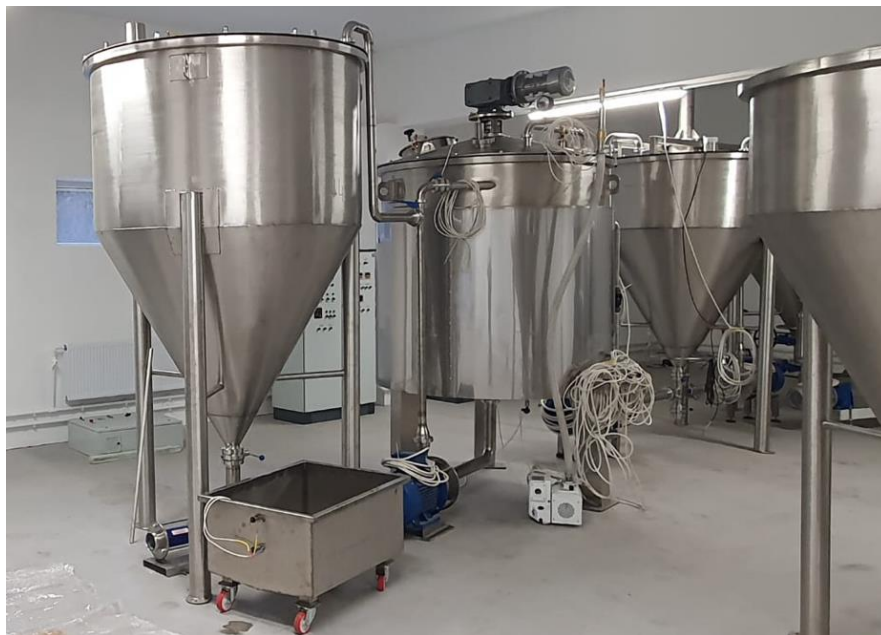
Рис.3.11. Первая стабилизационная колонна, вакуумный реактор, диссольтвер
