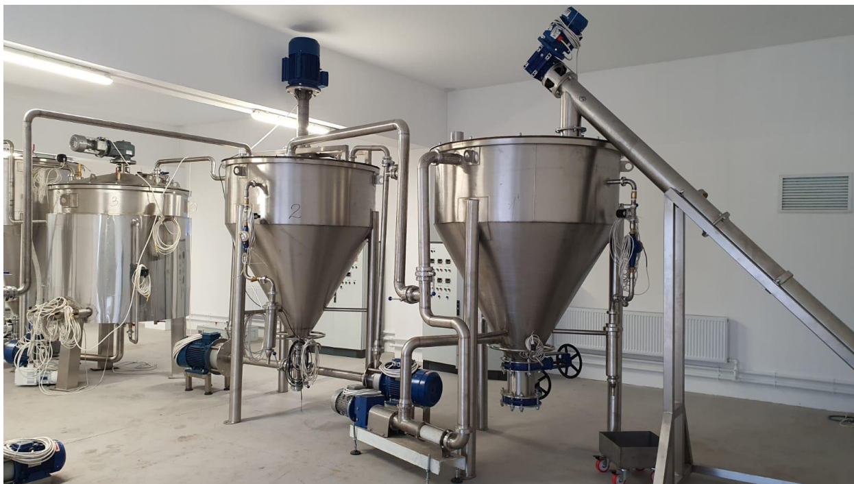
Рис.3.26. Слева на право: диссольтвер для геля, вторая стабилизационная колонна, первая стабилизационная колонна, вакуумный реактор
