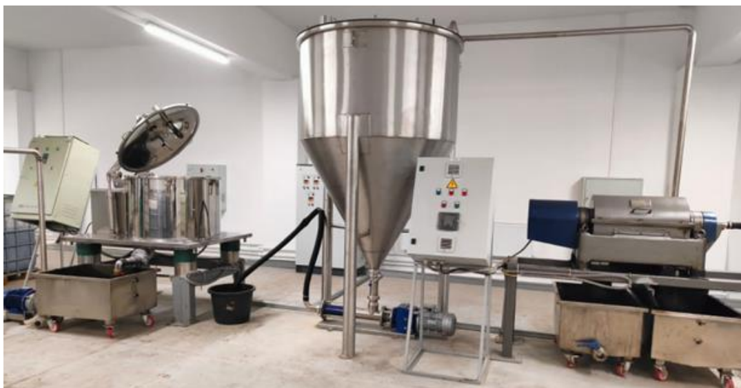
Рис.3.16. С права на лево:горизонтальная центрифуга, вторая стабилизационная колонна, вертикальная центрифуга, пульт управления, емкости для приема концентрата
