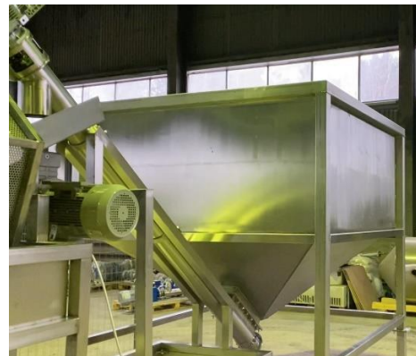
Рис.3.7. Приемная воронка бункер, сито шестигранное для предварительной очистки торфа, ленточный транспортер инспекционного тип РТЛИ с лампами УФ -излучения
