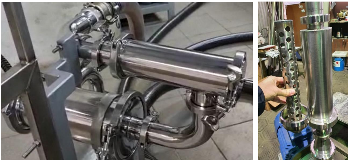
Рис.3.19. Фильтрация гуминового концентрата и воды
