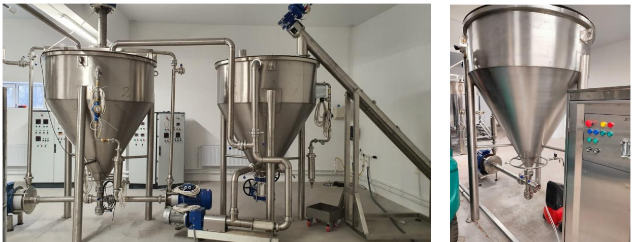
Рис.3.9. Ленточный скребковый транспортер, емкость промывки торфа, емкость насыщения структуры торфа озоном и воздухом
